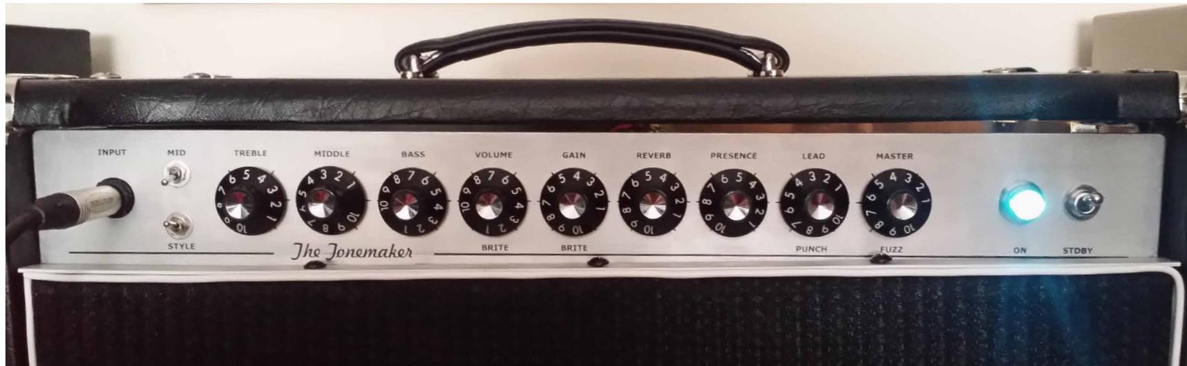
El amplificador es de 60W de potencia con 2 válvulas 6L6GC. Dispone de 5 válvulas de previo (4 de previo 12AX7 y una inversora 12AT7).
